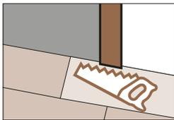
**Les encadrements de porte** doivent être coupés à la base pour permettre au revêtement de sol de se dilater.
