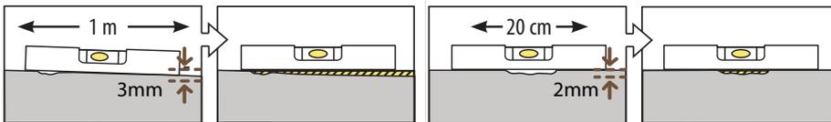
Assurez-vous que le **dénivelé maximum est** de 3 mm/m et de 2 mm sur 20 cm (au-delà, le support doit être aplani avec un enduit ou un produit de nivellement approprié. Toutes les saillies/arêtes isolées doivent être préalablement éliminées pour ne pas endommager le produit.
