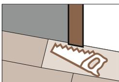
**Türzargen** sollten so gekürzt werden, dass die Dielen bis unter die Türzargen verlegt werden können.
