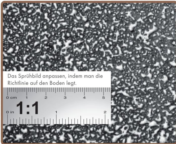
Das Sprühbild anpassen, indem man die Richtlinie auf den Boden legt.
